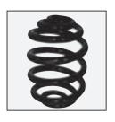
Miniblock-Federn werden auf den Hinterachsen einiger BMW, Opel, oder VW - Modellen verbaut. Auf Grund ihrer geringen Bauhöhe ermöglichen sie ein größeres Kofferraum-Volumen. Der durch die kurzen Federwege bedingte schlechtere Federungskomfort wird durch die Verwendung konischer Federstähle kompensiert. Dieses führt jedoch zu einer verkürzten Lebensdauer, insbesondere auf schlechten Wegstrecken, oder bei niedrigen Außentemperaturen.
