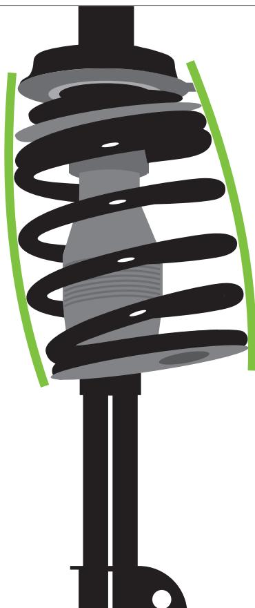
Un mal montaje podría dañar el tubo amortiguador y el alojamiento de la rueda.
