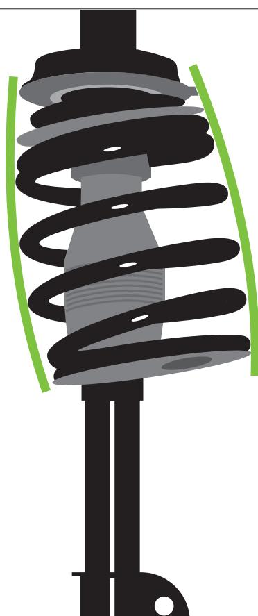
Неправильно выполненный монтаж может привести к повреждению амортизационной стойки, а также колесной арки.
